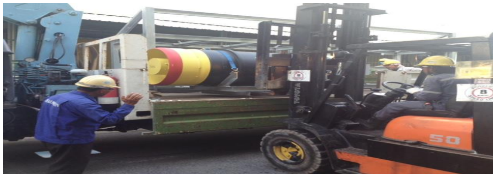
รูปที่ 4 การใช้งานรถยก (Fork Lift) เสียบขาเข้ากับ Support ของถังแอมโมเนีย (NH 3 )
